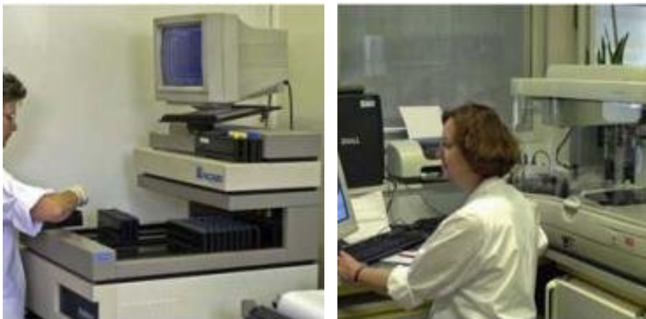
Figure 15 : réalisation des dosages par un automate capable de doser un marqueur en comptant la radioactivité d'un réactif de mesure
